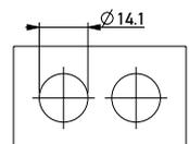
Montageloch für Verdreherschutz / Assembly hole for twist protection
