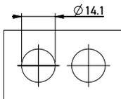
Montageloch für Verdreherschutz / Assembly hole for twist protection
